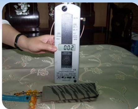
▲手機撥通後，置入於 電磁波遮蔽布 進行測試，電磁波值大幅降至 002 \mu\text{W}/\text{m}^2
