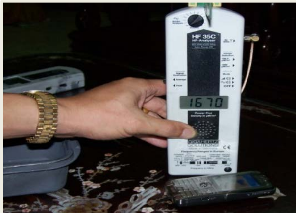
▲手機來電時，電磁波偵測值高達 1670 \mu\text{W}/\text{m}^2
