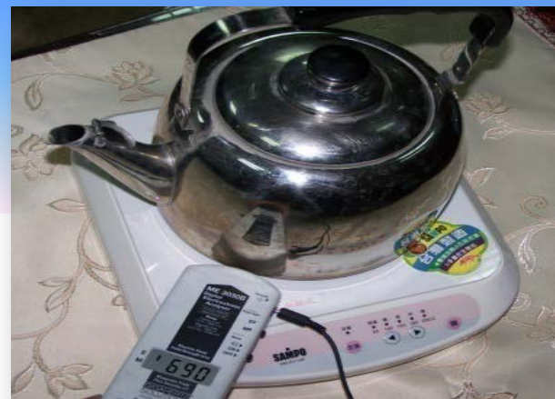
▲電磁爐啟動狀態，電磁波量測值高達 690 V/m
