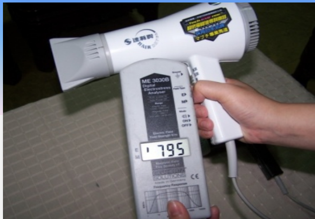
▲吹風機啟動時，電磁波量測值高達 795 V/m
