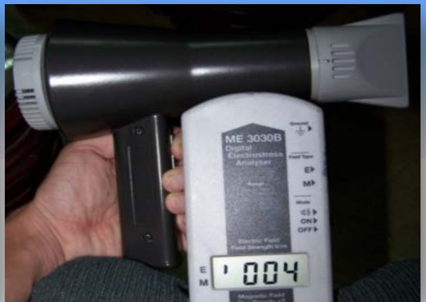
▲同品牌吹風機經 抗電磁波塗裝 後，電磁波值大幅降 004V/m
