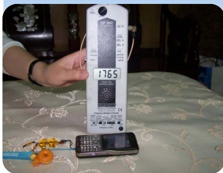
▲手機來電時，電磁波偵測值高達 1765 \mu\text{W}/\text{m}^2
